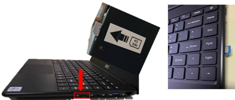
Inserir o cartão Micro LTE/4G no slot SIM card existente na lateral direita do equipamento, na direção indicada até ouvir um “clique” (o vértice “cortado” deverá ficar voltado para fora e o chip virado para cima).
